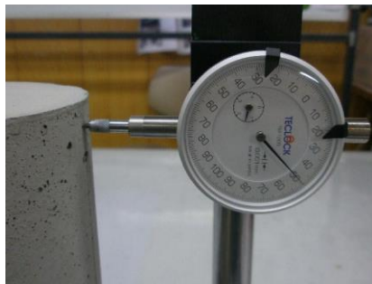
供試体を当てた時のダイヤルゲージの読み
