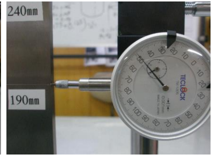
直角定規を当てた時のダイヤルゲージの読み
