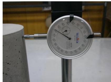
供試体を当てた時のダイヤルゲージの読み(90° 回転)
