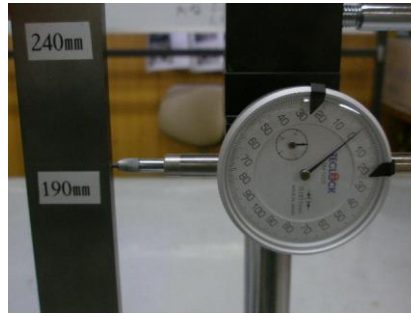
測定高の位置にダイヤルゲージ固定
